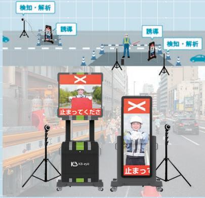
同社が開発した「KB-eye for 交通制御」のシステムは、通行車両や混雑状況などの映像をAIが分析し、LED看板に「止まれ」「進め」の信号を表示して、現場ごとに最適な交通制御を行います。通行車両を滞留させることなく誘導することができ、緊急車両の近接時や工事車両の出入り時などのイレギュラーな誘導が必要な場合は、オペレーターがリモコン操作で信号を切り替えることができます。
